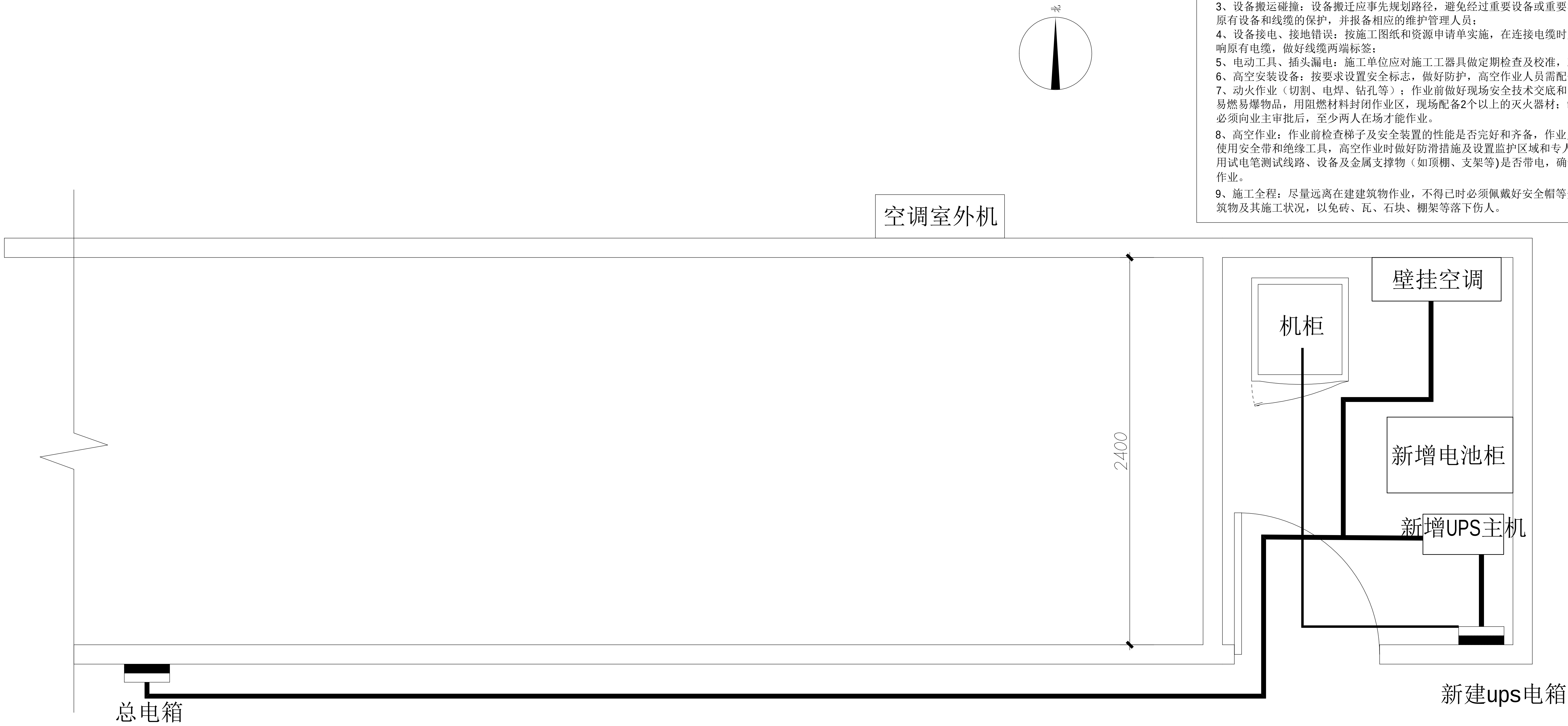
伙房机房设备路由平面图
